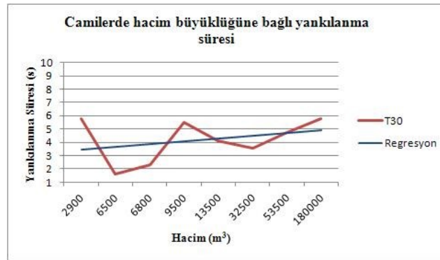
Şekil 4. Cami Yapılarında Hacim büyüklüğüne bağlı yankılanma süreleri
